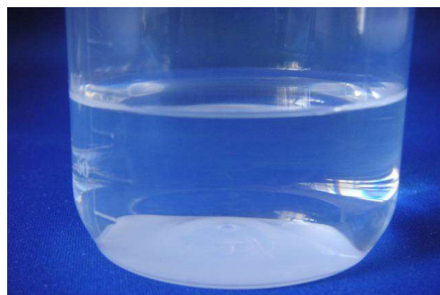
ニッケルメッキ用弊社変色防止剤 液のくすみ、沈殿なし
