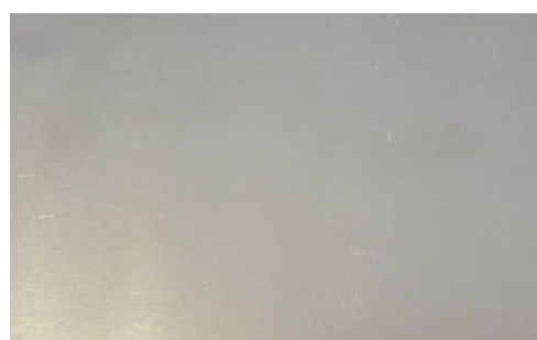
5%ニッケルメッキ用変色防止剤処理 SST3 時間後の Ni めっき鋼板の外観 変色・発錆なし
