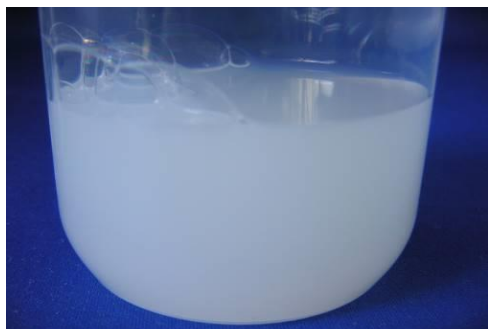
ニッケルメッキ用変色防止剤従来品 液のくすみが発錆
