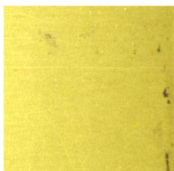
黄銅 変色防止未処理 1日後 変色発生
